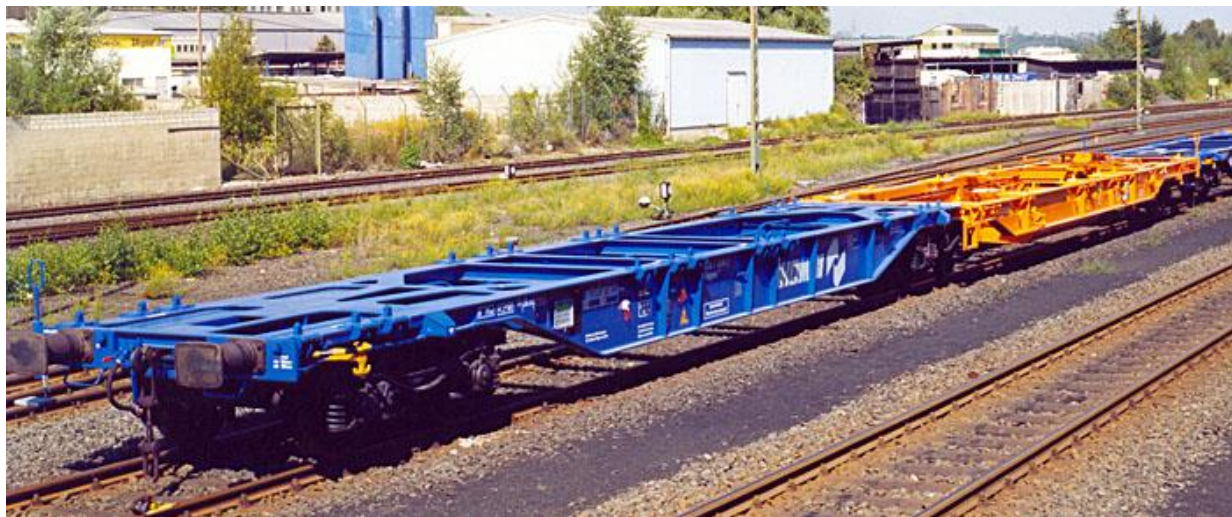
Obrázok 2: Príklad 1 jednotky skladajúcej sa zo skupiny trvalo spojených dvoch prvkov (modrý a oranžový), pričom tieto prvky nie je možné prevádzkovať samostatne (kíbový vozeň)
