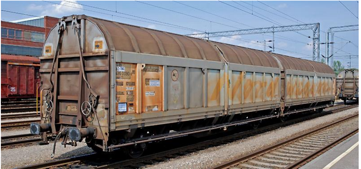
Obrázok 4: Príklad 3 jednotky skladajúcej sa zo skupiny trvalo spojených prvkov, pričom tieto prvky nie je možné prevádzkovať samostatne (samovykladací vlak)
