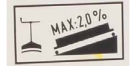
Príklad označenia „spádu brzdeného ručnou brzdou“
